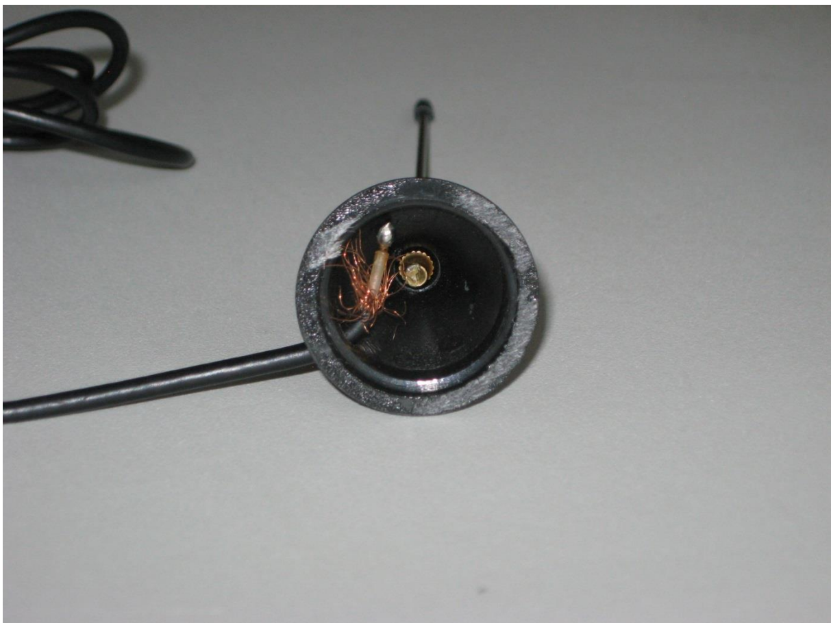
Foto 3 – Niet erg degelijk, dat soldeerwerk...
